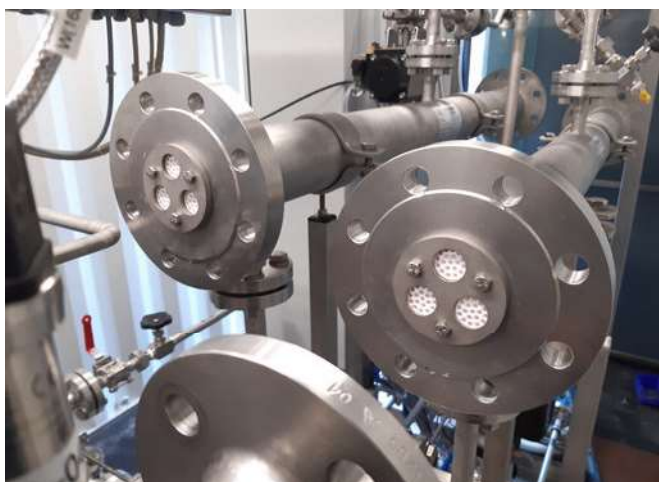
Bild 2: In Edelstahl-Filtrationsgehäusen eingesetzte keramische Rohrmembranen mit 19-Kanalgeometrie
